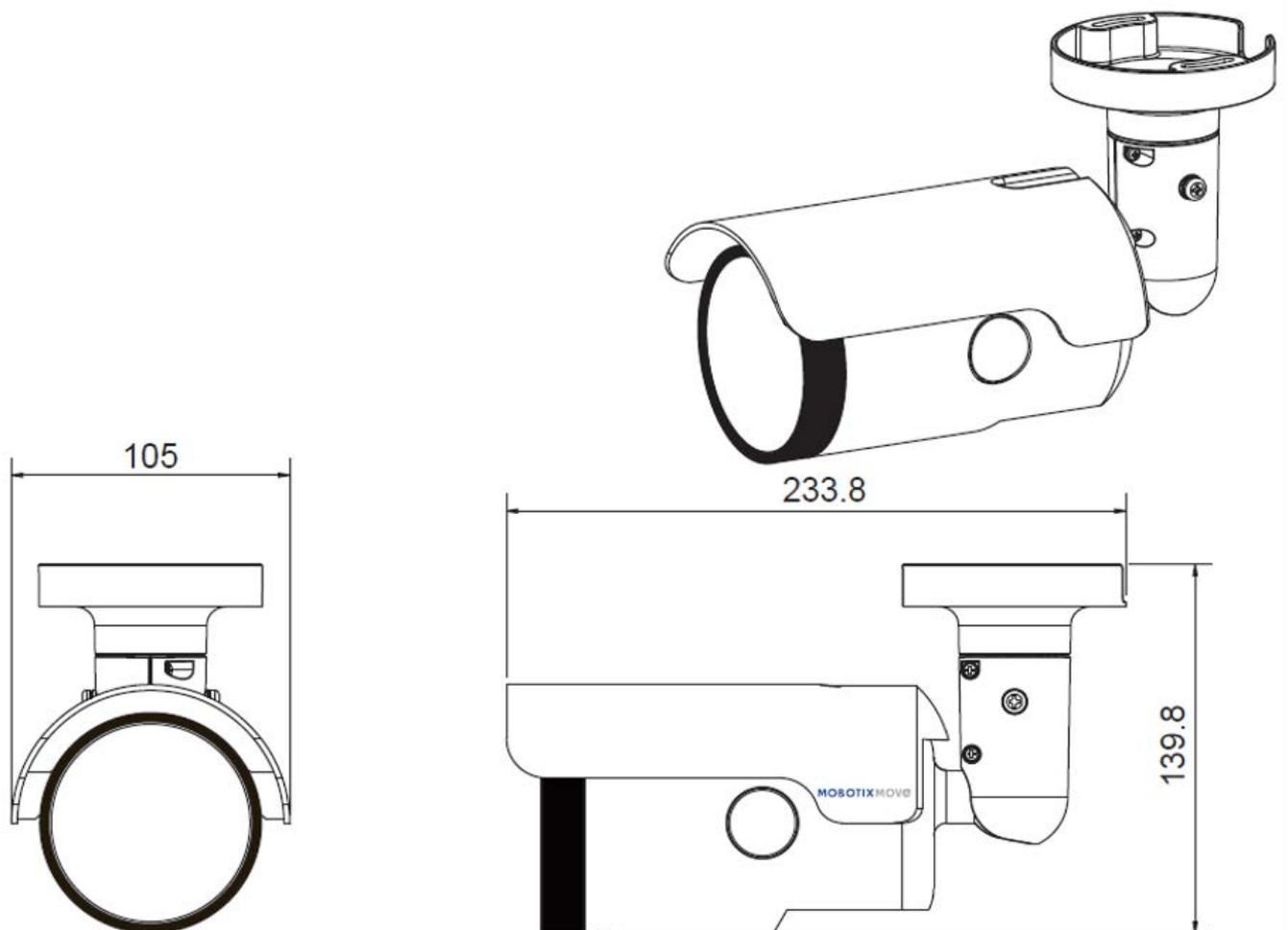
Fig. 1: Mx-VB3A-2-IR-VA: Tutte le misure sono espresse in mm
