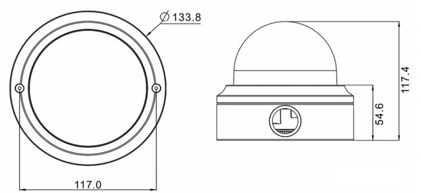
Fig. 1: Mx-VD3A-2-IR-VA: Tutte le misure sono espresse in mm
