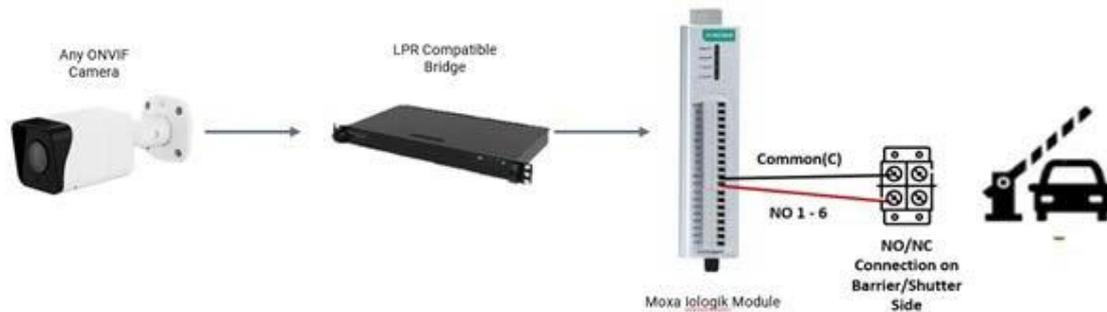
Figure 121. Conexión Moxa a una barrera/obturador
