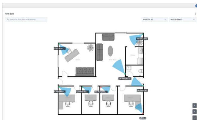
Figure 91. Visualizzazione delle posizioni di tutte le telecamere su una planimetria
