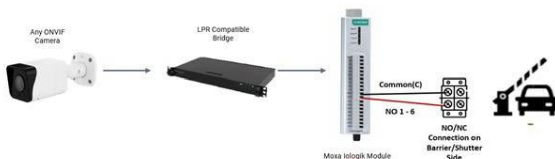
Figure 121. Collegamento Moxa a una barriera/persiana
