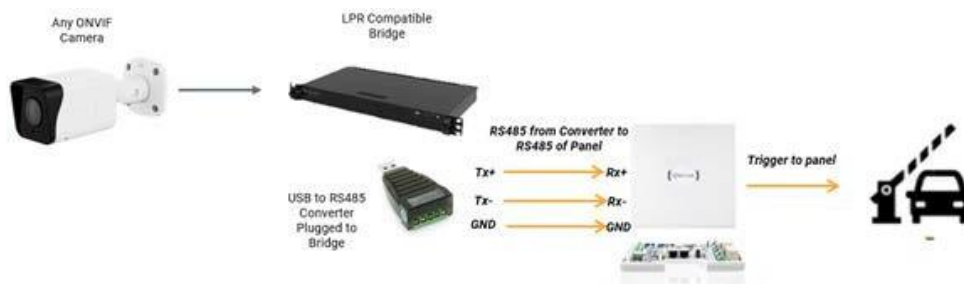
Figure 117. Collegamento tra il ponte Mobotix e il pannello Brivo tramite un convertitore da USB a RS485
