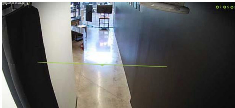
Figure 100. Analytics: Visualizzazione del conteggio degli oggetti che attraversano le linee
