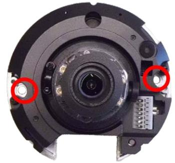
7. Befestigen Sie die Kuppelabdeckung an der Kamera und ziehen Sie die zwei Kreuzschlitzschrauben fest.
