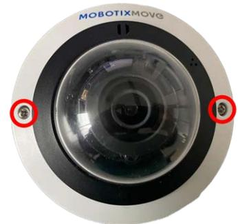
2. Platzieren Sie die Kamera am Montageort (bei der Installation der Kamera an einer Wand sollte sich die Kabeleinführung immer unten befinden). Markieren Sie die Position der beiden Schraubenlöcher, die durch die roten Kreise in der Abbildung an der Decke oder Wand gekennzeichnet sind (der rote Pfeil zeigt an, wo das Ethernet-Kabel in die Kamera gelangen wird).
