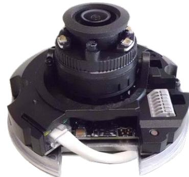
6. Far combaciare i due fori delle viti della telecamera con gli ancoraggi a vite in plastica nella posizione di installazione. Fissare la telecamera con le viti autofilettanti fornite in dotazione.
