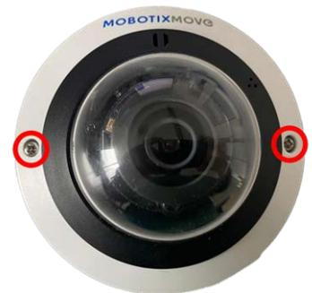
2. Posizionare la videocamera nella posizione di installazione (quando si installa la videocamera a una parete, l'ingresso del cavo deve essere sempre nella parte inferiore). Contrassegnare la posizione dei due fori delle viti indicati dai cerchi rossi nella figura sul soffitto o sulla parete (la freccia rossa indica il punto di ingresso del cavo Ethernet nella videocamera).
