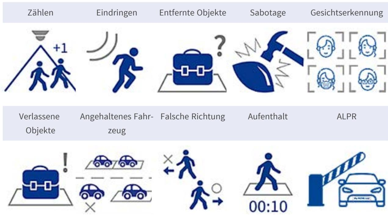
Die neueste Computer-Vision-Technologie macht die DNN-beschleunigte Videoverarbeitungs-Engine an der Kante effizient. Diese integrierte Engine bietet hohe Genauigkeit, Objektverfolgung in Echtzeit und 10 (DNN-basierte) Videoanalysefunktionen, einschließlich ALPR und Gesichtserkennung. Außerdem ermöglicht sie die gleichzeitige Erkennung mehrerer Objekte.
