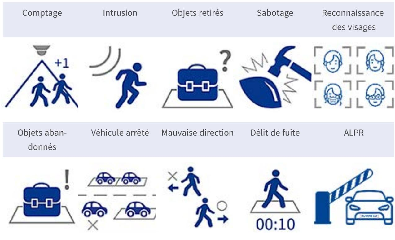
La dernière technologie de vision par ordinateur rend le moteur de traitement vidéo accéléré par DNN efficace à la périphérie. Ce moteur intégré offre une grande précision, un suivi des objets en temps réel et 10 fonctions d'analyse vidéo (basées sur le DNN), notamment l'ALPR et la reconnaissance des visages humains. En outre, il permet la détection simultanée de plusieurs objets.
