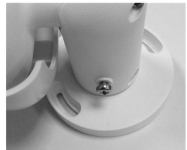
2. Wenn die Löcher für die Schrauben durch das Kameragehäuse verdeckt sind, lockern Sie die in der rechten Abbildung dargestellte Schraube, lösen Sie sie jedoch nicht. Drehen Sie dann das Kameragehäuse so, dass Sie die Löcher für die Schrauben erreichen können.
