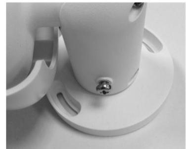
2. Si los orificios para los tornillos están tapados por el cuerpo de la cámara, afloje el tornillo que se muestra en la figura de la derecha, pero no lo saque. A continuación, gire el cuerpo de la cámara para poder llegar a los orificios para los tornillos.
