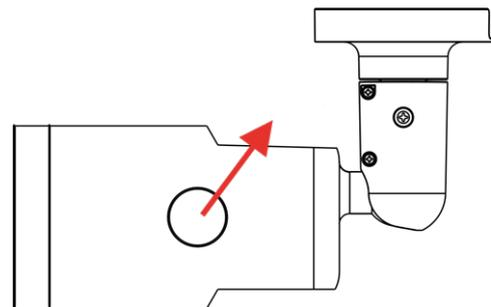
2. Aprire il coperchio interno utilizzando un cacciavite Torx.
