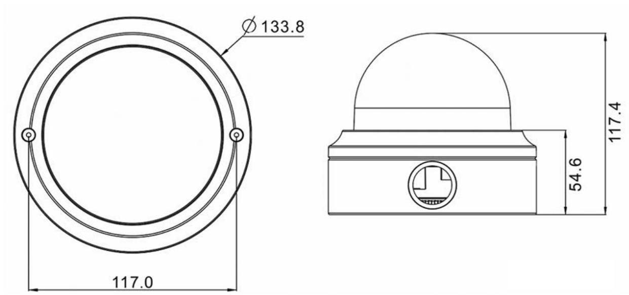
Fig. 1: Mx-VD2A-5-IR-VA: Todas las medidas en mm
