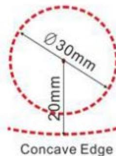
4. Perfore el orificio de entrada del cable.
