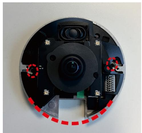
3. En el techo o la pared, dibuje un punto 20 mm por encima del centro del borde cóncavo marcado. Establezca el punto marcado como centro y dibuje un orificio de entrada de cable con un diámetro de 30 mm (radio de 15 mm).
