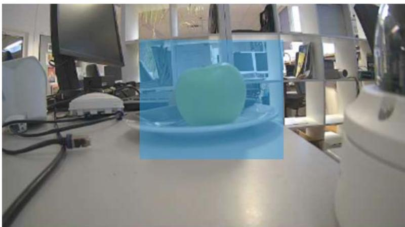
Une zone de confidentialité masque une zone d'image définie pour protéger la vie privée. Elle s'applique à tous les flux, à l'enregistrement et à l'affichage en direct, et n'a aucune influence sur les fonctions d'analyse telles que la détection de mouvement. Vous pouvez définir jusqu'à 8 zones de confidentialité différentes. Après avoir défini une zone de confidentialité, un cadre s'affiche dans la vue en direct, dont la couleur, la taille et la position peuvent être réglées.
