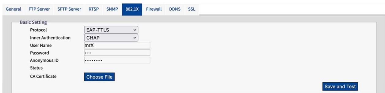
IEEE 802.1X est une norme pour l'authentification dans les réseaux informatiques et définit l'encapsulation du protocole d'authentification extensible (EAP) via IEEE 802.
