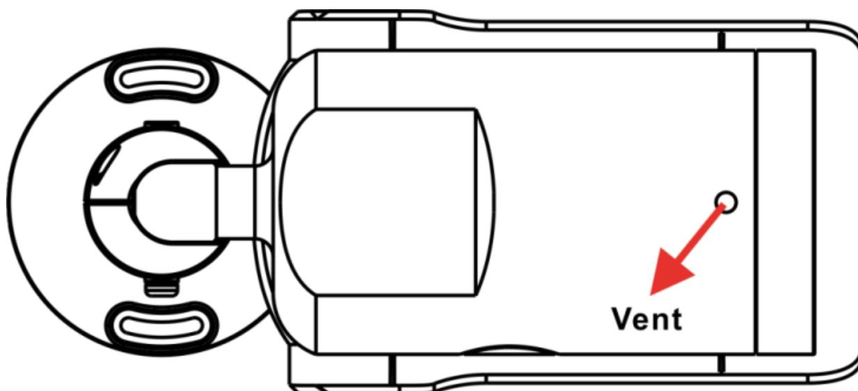
**ATTENTION !** Le retrait de l'emballage des déshydratants active le système de ventilation et l'humidité peut pénétrer dans le boîtier de la caméra si ce dernier n'est pas mis sous tension immédiatement après son installation !
