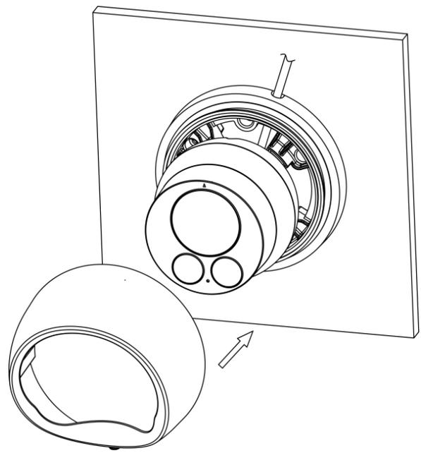
Montaje de la cámara y tendido del cable Ethernet en la superficie
