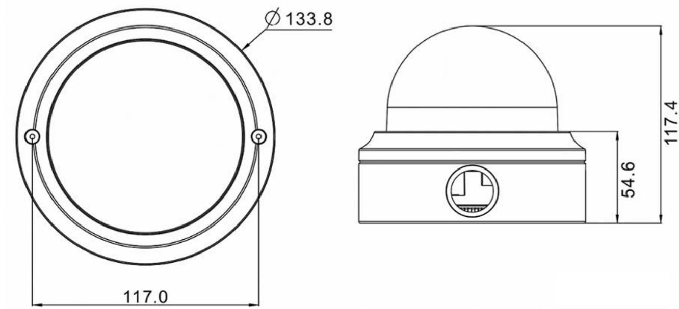
Fig. 1: Mx-VD2A-2-IR: Todas las medidas en mm
