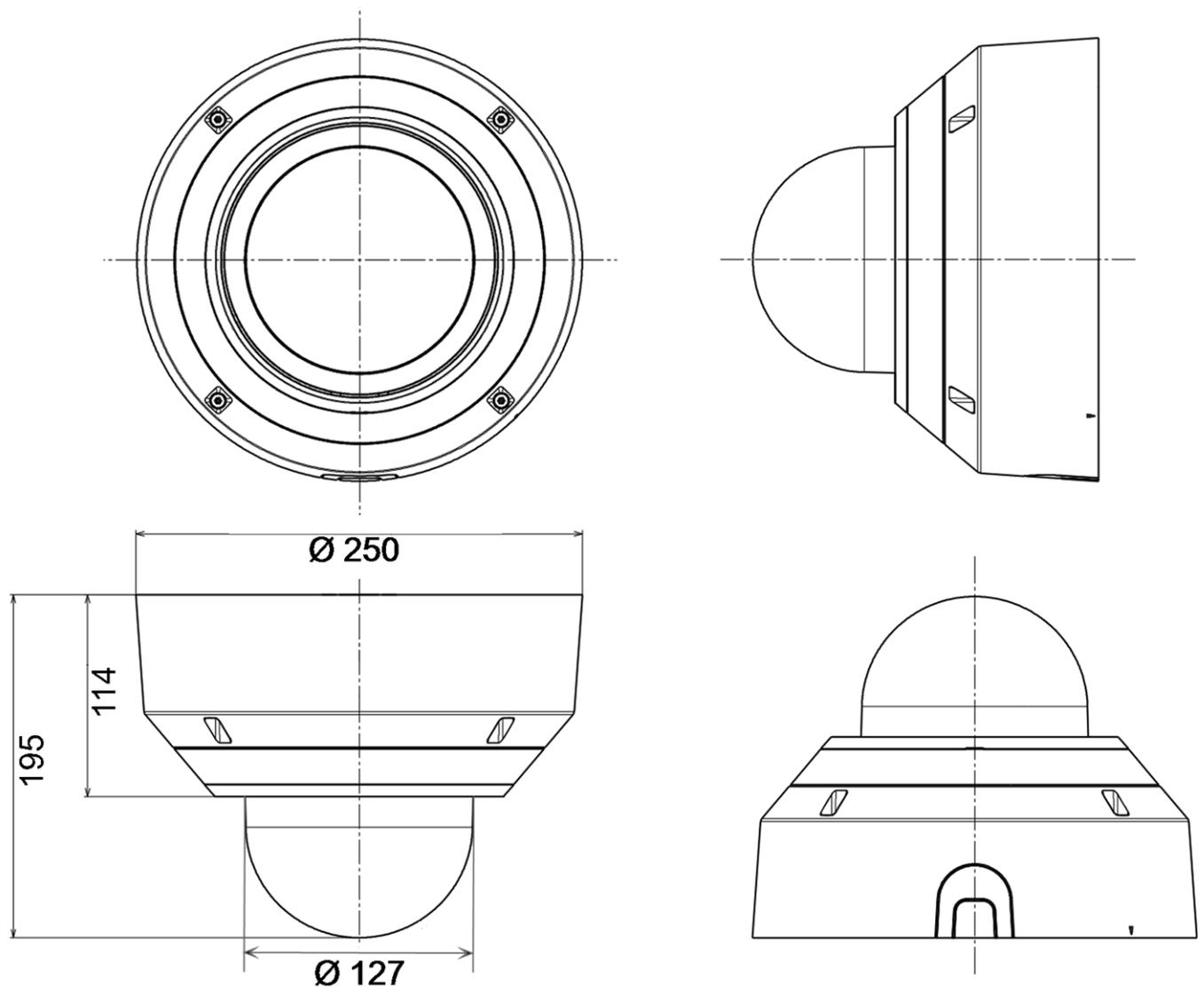
Fig. 1: Mx-VMSD1A-2021-VA: Todas las medidas en mm
