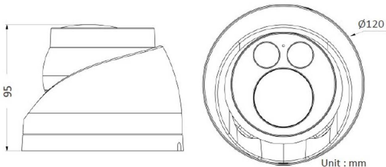
Fig. 1 : Mx-VT1A-2-IR: Toutes les mesures sont en mm
