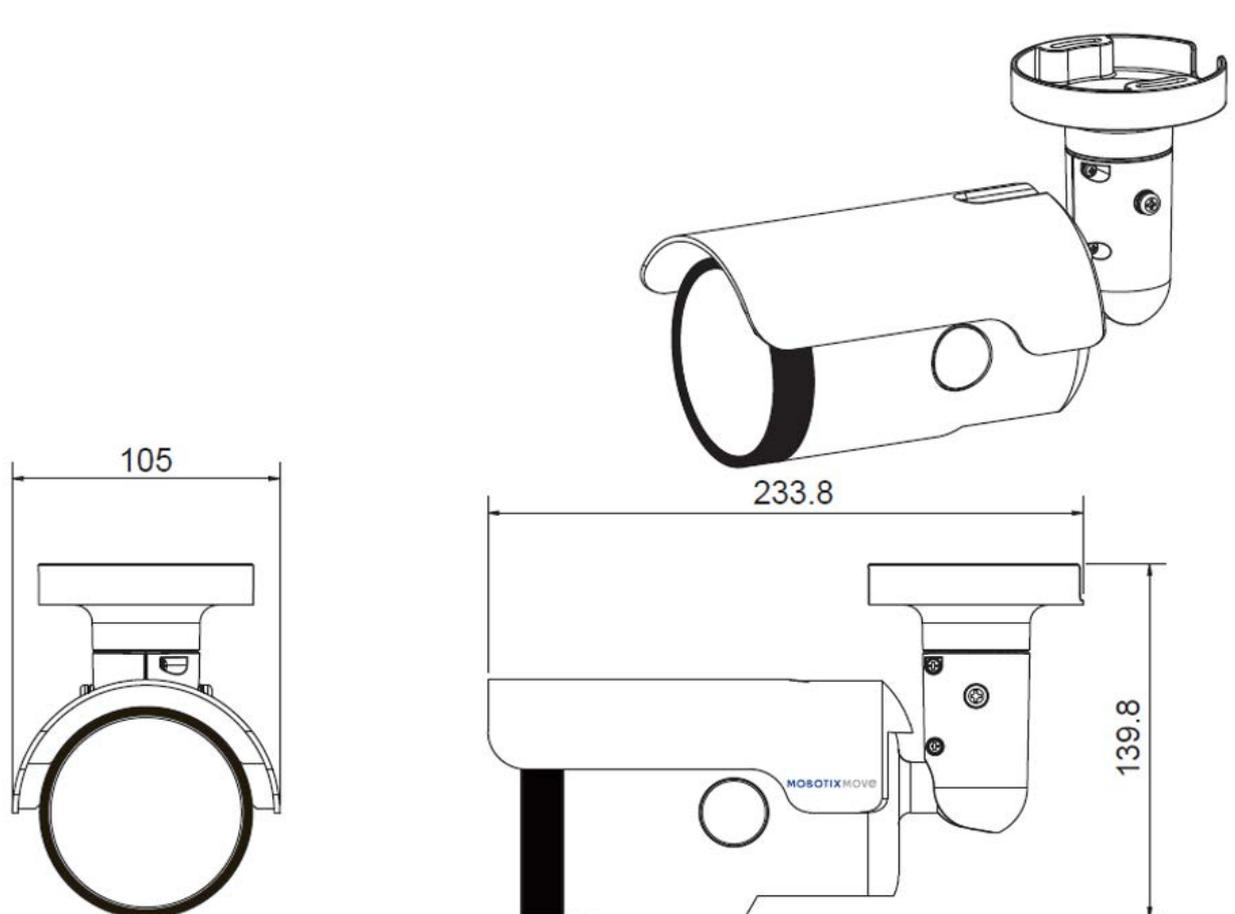
Fig. 1 : Mx-VB1A-8-IR-VA: Toutes les mesures sont en mm
