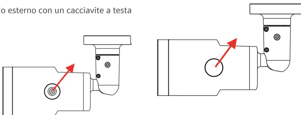
3. Le posizioni dello slot per la scheda microSD e del pulsante predefinito sono quelle indicate.
