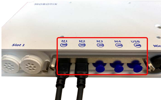
Abb. 3: 4 Modulanschluss-Ports und 1 USB-C-Schnittstelle
