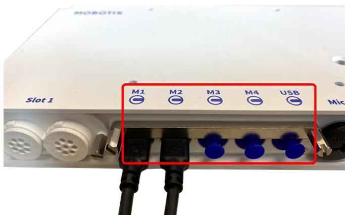
Fig. 3: 4 porte connettore modulo e 1 interfaccia USB-C
