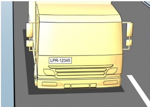
Position auf der Fahrspur (zur Begrenzung des Erkennungsbereichs nach rechts und links)
