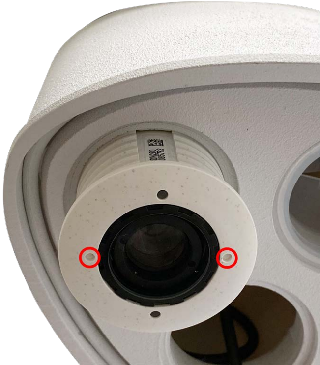
Abb. 9: Entriegeln Sie das Sensormodul
