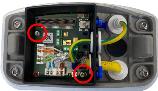
Abb. 31: Montieren Sie die Anschlussdose LSA (Ansicht von oben) mit den beiden Schrauben (in der Abbildung rot hervorgehoben) auf der Montageplatte
