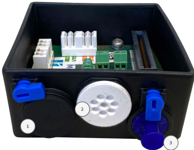
Abb. 20: Anschlussdose LSA mit Gummistecker schwarz C.3 ① , Gummistecker Einzeladern C.4 ② , USB-Stecker ③ und zwei blauen Verschlüssen
