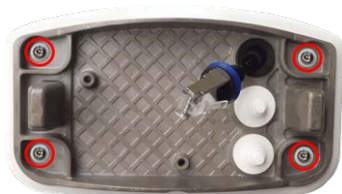
Abb. 11: Installiert und bereit für Anschlussdose RJ45
