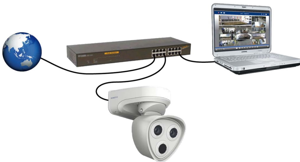
Abb. 19: Stromversorgung über PoE-Switch gemäß PoE Plus (802.3at-2009).
