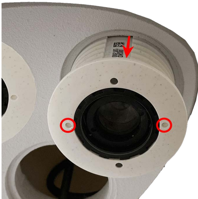
Abb. 10: Sensormodul aus dem Modulgehäuse entfernen
