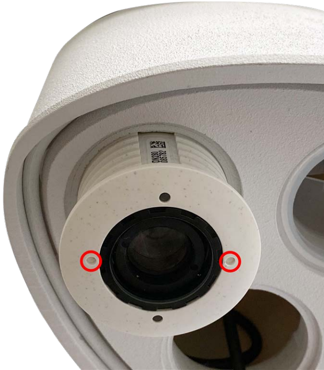
Fig. 9 : Déverrouiller le module de détection
