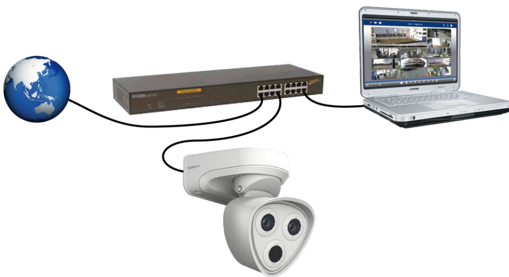
Fig. 19 : Alimentation électrique à l'aide d'un commutateur PoE conformément à PoE Plus (802.3at-2009).
