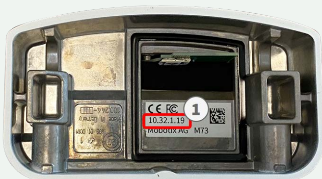
Fig. 5: Indirizzo IP sul retro dell'alloggiamento della telecamera
