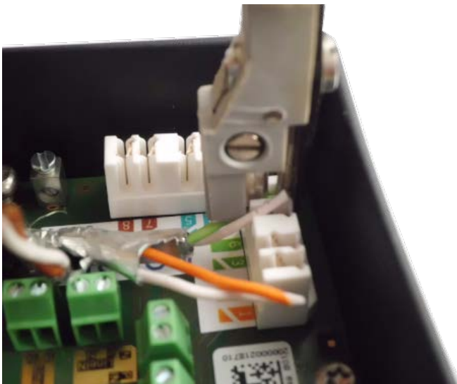
Abb. 27: Mit dem LSA+/Krone-Tool angeschlossene Netzwerkdrähte
