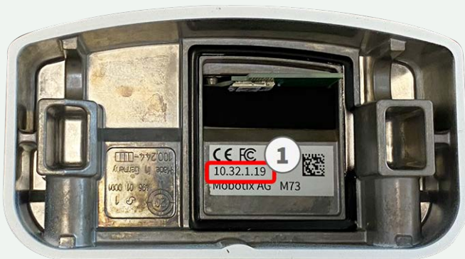
Abb. 5: IP-Adresse auf der Rückseite des Kameragehäuses
