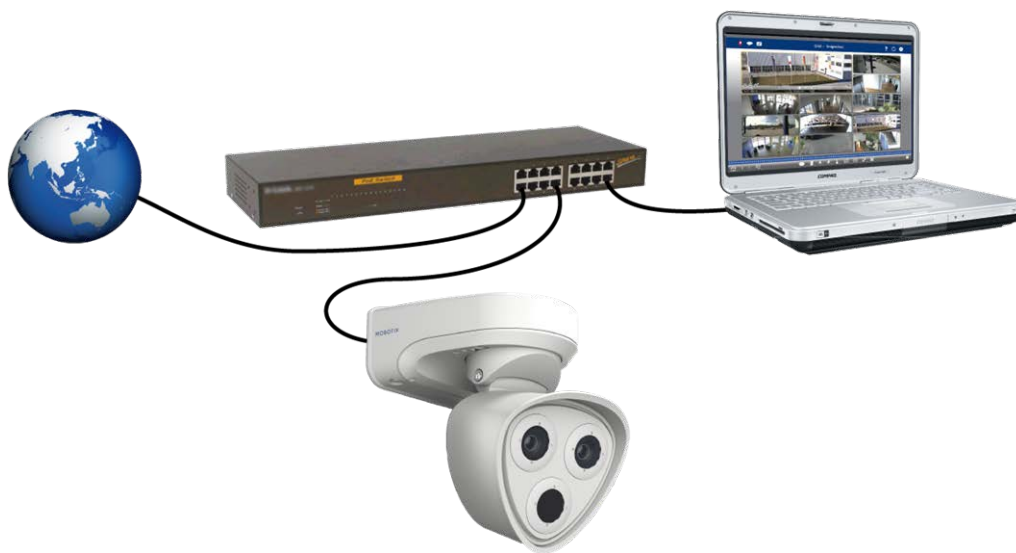
Abb. 19: Stromversorgung über PoE-Switch gemäß PoE Plus (802.3at-2009).
