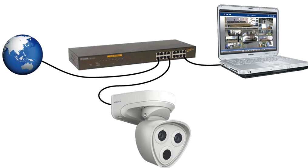
Fig. 19: Alimentación mediante interruptor PoE según PoE Plus (802.3at-2009).
