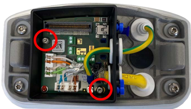
Fig. 31: Monte el Caja de conexiones LSA (vista superior) utilizando los dos tornillos (resaltados en rojo en la figura) de la placa de montaje.
