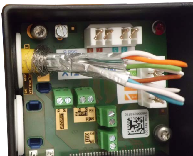
Fig. 24: Cable de red insertado, enchufe correctamente asentado
