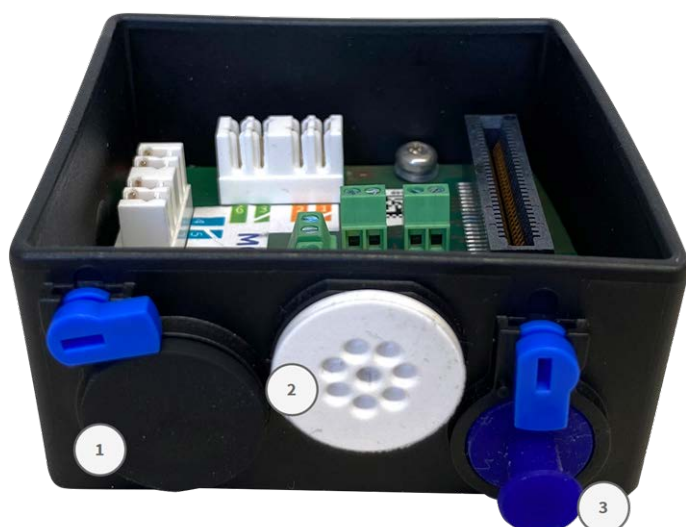
Fig. 20 : Boîte de connexion LSA avec fiche en caoutchouc noire C.3 ① , fiche en caoutchouc monofilaire C.4 ② , fiche USB ③ et deux cadenas bleus
