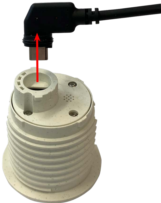
Fig. 8 : Retirer le câble du module de détection
