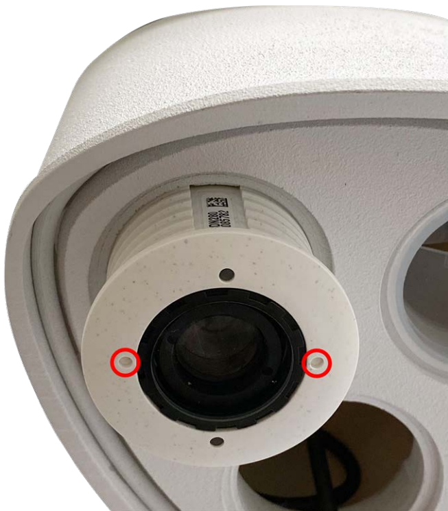
Fig. 9: Sbloccare il modulo sensore
