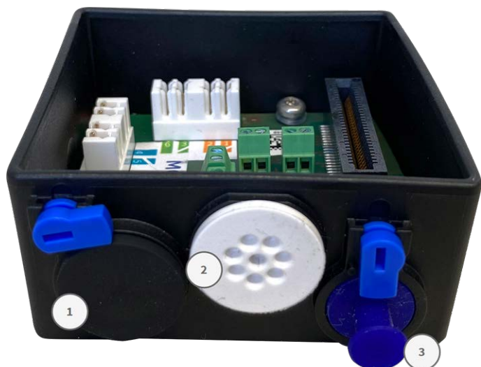
Fig. 20: Scatola di connessione LSA con spina in gomma nera C.3 ① , spina in gomma monofilare C.4 ② , spina USB ③ e due lucchetti blu
