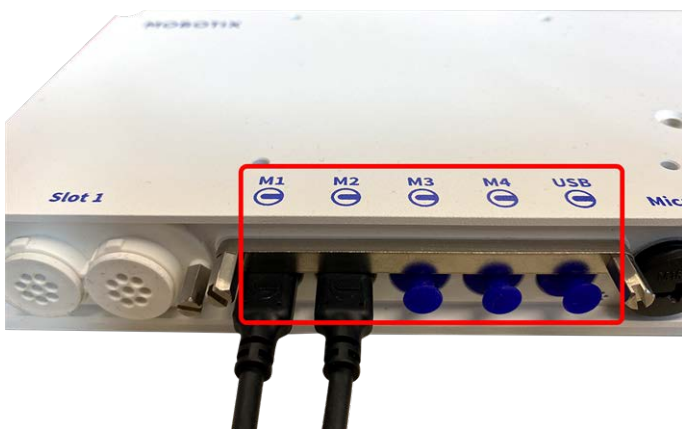
Abb. 8: 4 Modulanschluss-Ports und 1 USB-C-Schnittstelle
