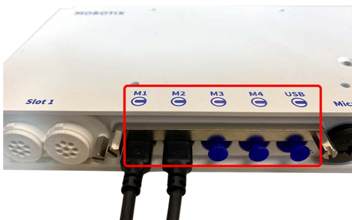
Fig. 8: 4 puertos de conector de módulo y 1 interfaz USB-C
