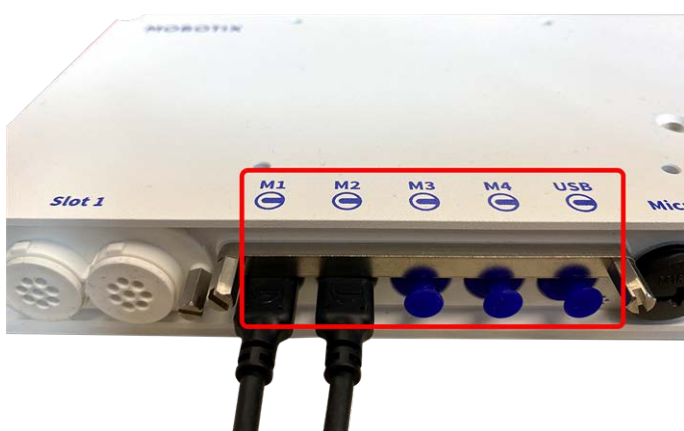
Fig. 8 : 4 ports de connexion de module et 1 interface USB-C
