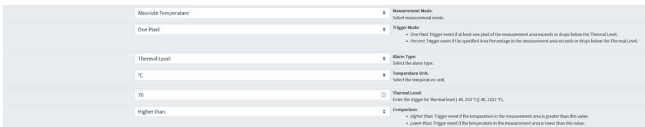
Abb. 7: Einstellungen des Radiometrie-Ereignisprofils für den Voralarm.
