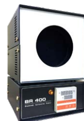
Fig. 9 : Calibration Radiator BR400 par Optris
