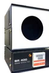
Fig. 8: Calibration Radiator BR400 di Optris
