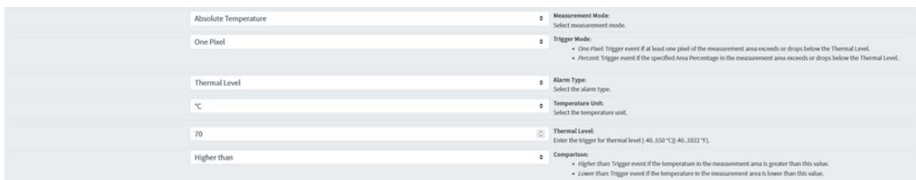
Abb. 7: Einstellungen des Radiometrie-Ereignisprofils für den Voralarm .
