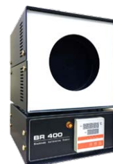
Fig. 12: Calibration Radiator BR400 de Optris
