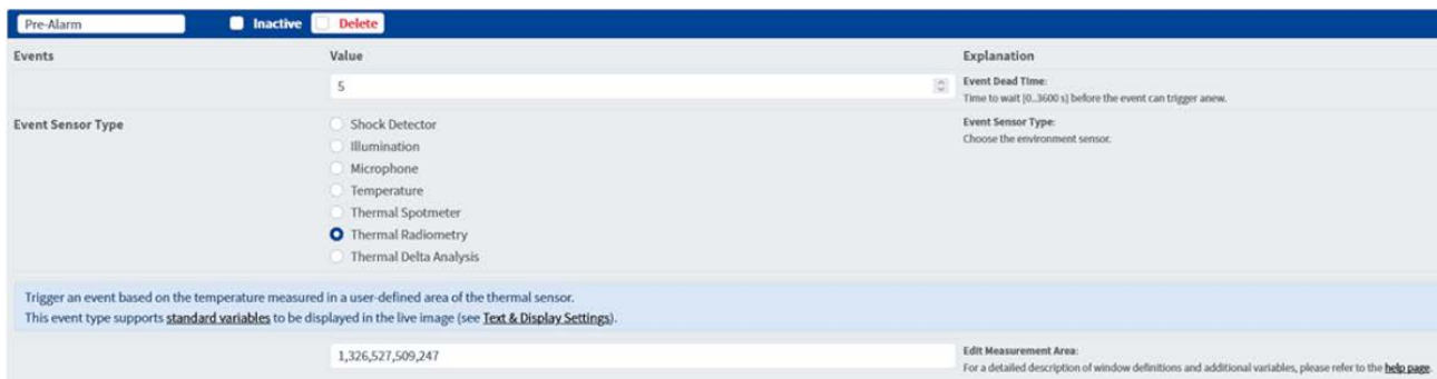
Fig. 9: Perfil del evento radiométrico previo a la alarma con área de medición.
