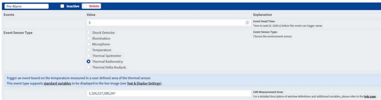
Abb. 5: Radiometrisches Voralarm -Ereignisprofil mit Messbereich.
