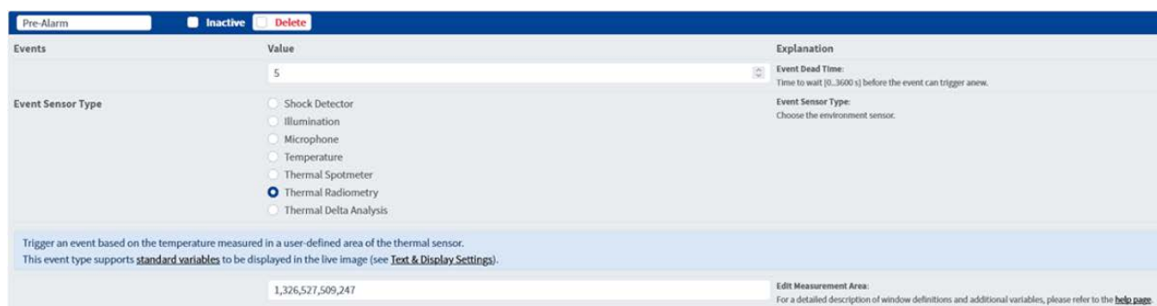
Fig. 5: Profilo dell'evento radiometrico pre-allarme con area di misura.
