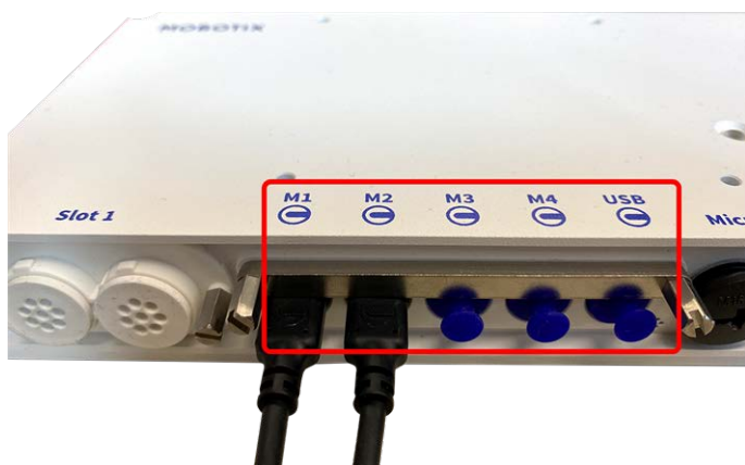
Fig. 3: 4 puertos de conector de módulo y 1 interfaz USB-C
