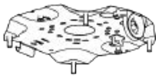
Plaque de base (fixée à la caméra)
