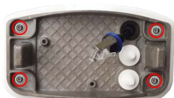
Abb. 12: Installiert und bereit für Anschlussdose RJ45
