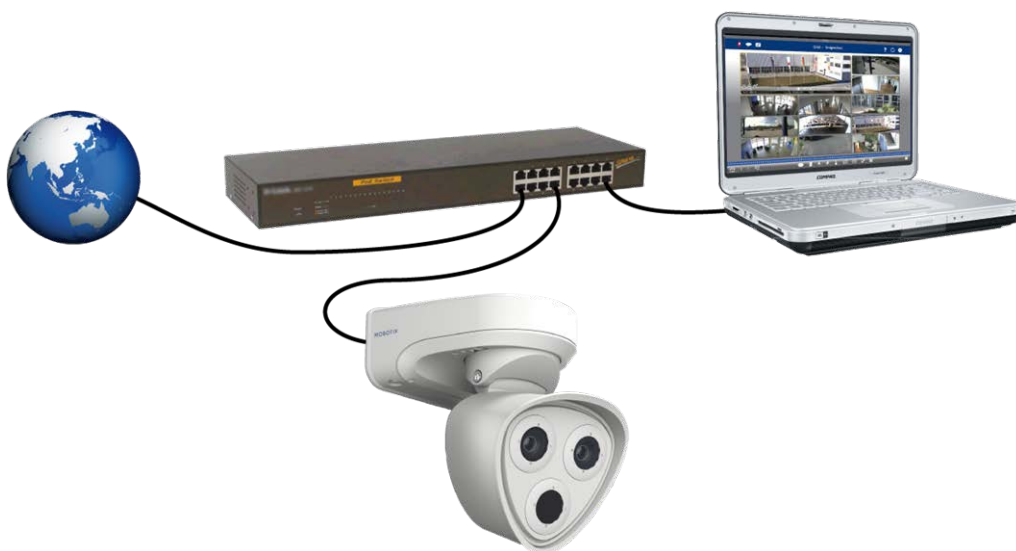
Abb. 14: Stromversorgung über PoE-Switch gemäß PoE Plus (802.3at-2009).
