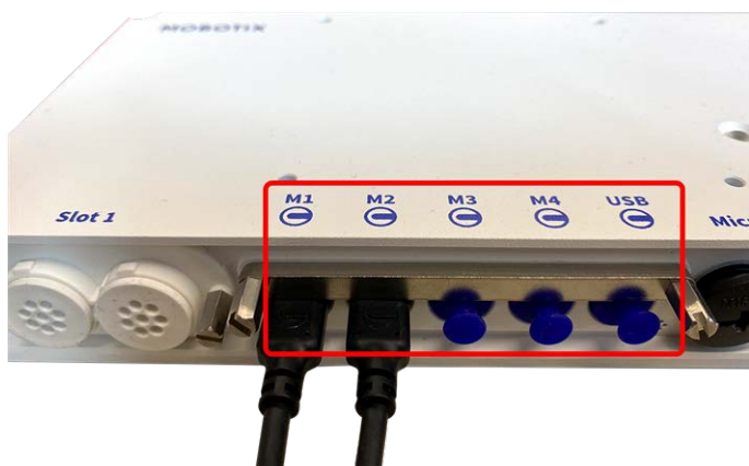
Fig. 5: 4 puertos de conector de módulo y 1 interfaz USB-C
