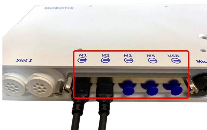
Fig. 5: 4 porte connettore modulo e 1 interfaccia USB-C
