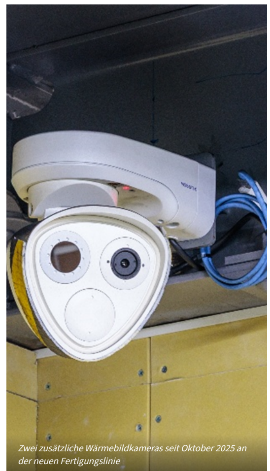
Wärmebild und Echtbild gleichzeitig aufgezeichnet — ein Fehlalarm ist auf einen Blick erkennbar
