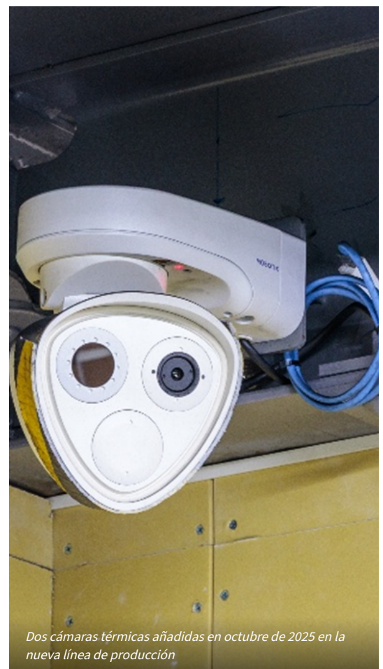
Imágenes térmicas y visibles grabadas simultáneamente: una falsa alarma se confirma de un vistazo
