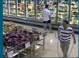
Erkennt und verfolgt Personen im Blickfeld der Kamera. Alarme können ausgelöst werden, wenn Personen bestimmte Bereiche unbefugt betreten. Verweilzeiten werden erfasst und aufgezeichnet, um ungewünschtes Herumlungern zu melden. Mit Heat Maps lassen sich gerade im Einzelhandel Bereiche ausfindig machen, die stark frequentiert sind oder in denen Kunden besonderes Interesse zeigen.
